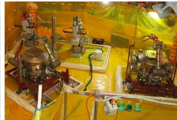
自動探傷装置 (渦流・超音波探傷試験共用)
